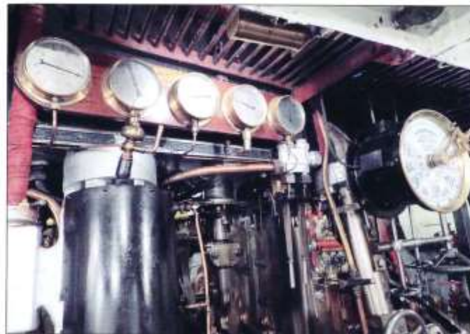
Manometrarna på BOHUSLÄNS maskin vid full fart under Stockholm Steam visar från vänster vakuüm i kondensorn, trycket i lågtrycks-cylindern, i mellantrycks-cylindern samt i högtrycks-cylindern. Foto Gunnar Söderberg
